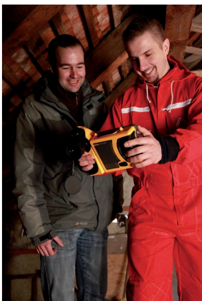
Test provedené izolace pomocí termokamery
